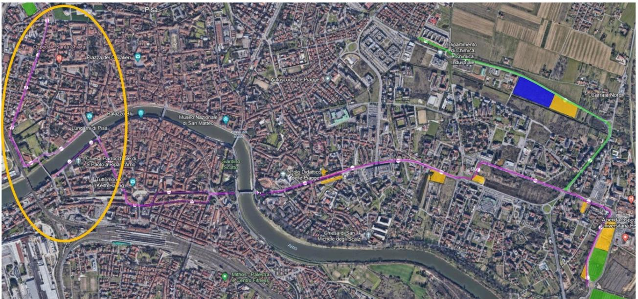
Figura 3.3.9 – Planimetria ultima versione percorso approvato tramvia
